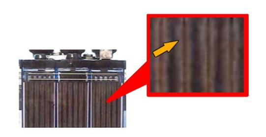
鉛バッテリーは化学反応の繰り返しの中で次第に電極板に 硫酸鉛の結晶化が進行します。 (サルフェーション)
